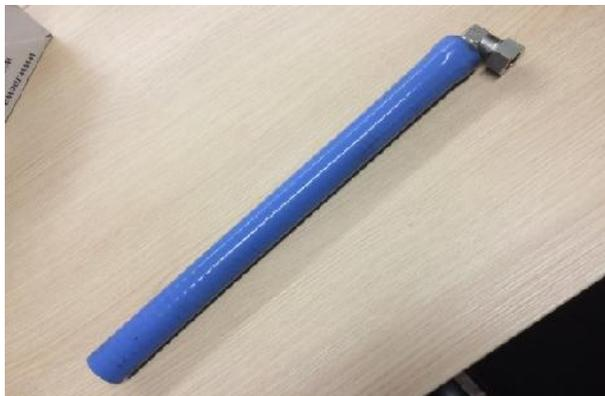
Schalldämpfer mit 90° Luftableitung (Bild: ILI/JH)
